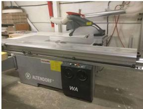
Scie à panneau avec système de dépoussiérage
