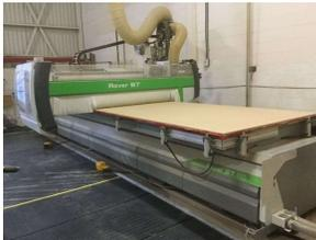
Centre d'usinage à contrôle numérique CNC
