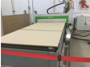
Centre d'usinage à contrôle numérique CNC
