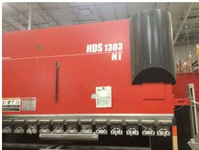
Presse plieuse hydraulique, cap.: 143 tonnes X 10'
