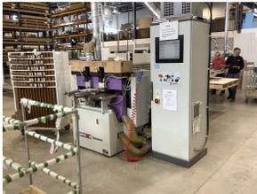
Tenonneuse et mortaise à contrôle numérique CNC
