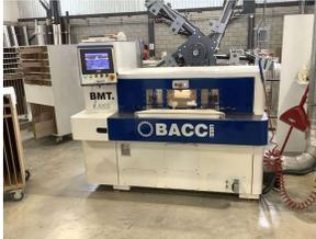
Tenonneuse à contrôle numérique CNC
