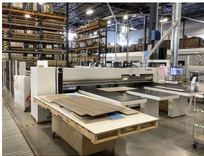
Scie à panneaux horizontale à contrôle numérique CNC
