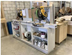
Scie à onglet avec cabinet d'aspiration
