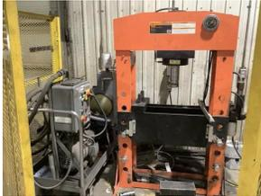
Presse hydraulique avec unité hydraulique
